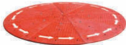
Composta da 8 elementi modulari (da kg 77 l'uno) realizzati in gomma vulcanizzata. Montaggio facile e veloce; l'intera isola si fissa con 48 viti con tasselli; buona visibilità, anche notturna e in cattive condizioni meteorologiche, grazie alle strisce retro-riflettenti e ai marker in vetro integrati in ogni singolo elemento. Accessori per l'assemblaggio: tappi, viti e bulloni di ancoraggio. Colori disponibili: nero e rosso mattone, entrambi con strisce bianche retroriflettenti.
