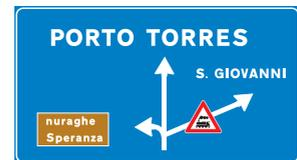
Segnale di preavviso di intersezione con passaggio a livello su un ramo dell'intersezione
