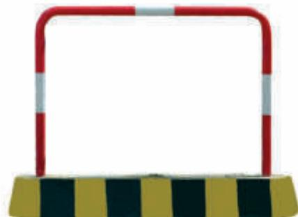
Prodotto realizzato in conglomerato cementizio (cm 150x30x20h, kg 160), verniciato a fasce gialle e nere per maggiore visibilità, con fori per inserimento di archetto Ø mm 48 o 60 (cm 130x100h) curvato, zincato e verniciato, dotato di fasce rifrangenti. A richiesta, fornito con lamiera per applicazione pubblicità.
