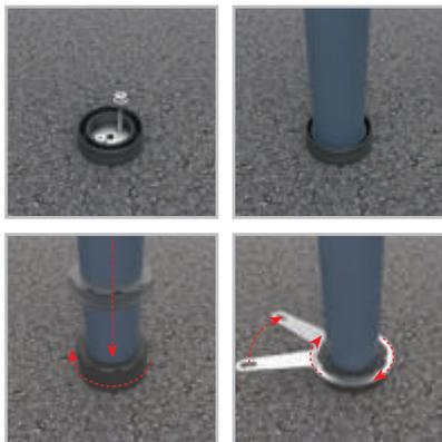
Realizzato in poliuretano, caratterizzato da alta elasticità in tutte le direzioni e ritorna all'originale forma e posizione dopo il distorcimento. Colore grigio antracite, dotato di 2 fasce adesive rifrangenti classe 2. Completo di piastra da tassellare tramite 2 viti e tasselli Ø 18x105 (inclusi) e piastra copri-installazione da avvitare.
