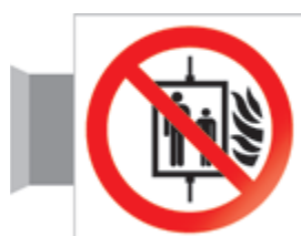
SECT18 Vietato usare l'ascensore
